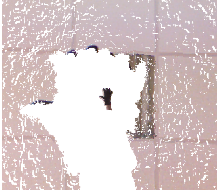
FIG. 1 : Image perçue par la kinect sans le nœud filter , dans le cas d'un gant noir porté par l'utilisateur (cf. figure 2 page 9).
